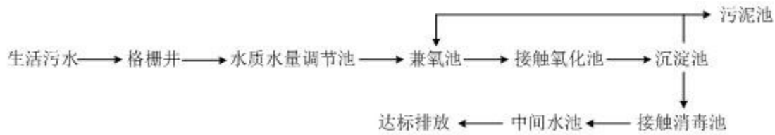
图 9-2 收费站污水处理设备工艺流程示意图
