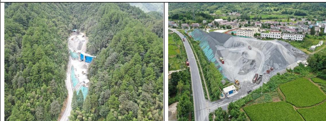
隧道洞渣破碎后作为建筑骨料综合利用
